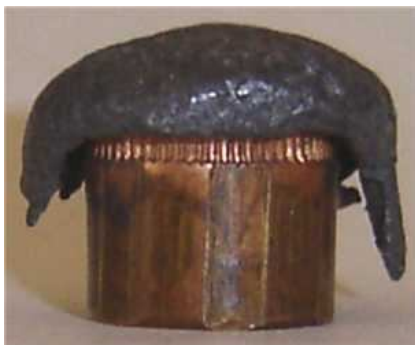
Bala calibre .44-40 marca Winchester. Proyectoil de 200 grains de peso despues de haber impactado en un jabali a 60m. FOTO: ROBERTO
