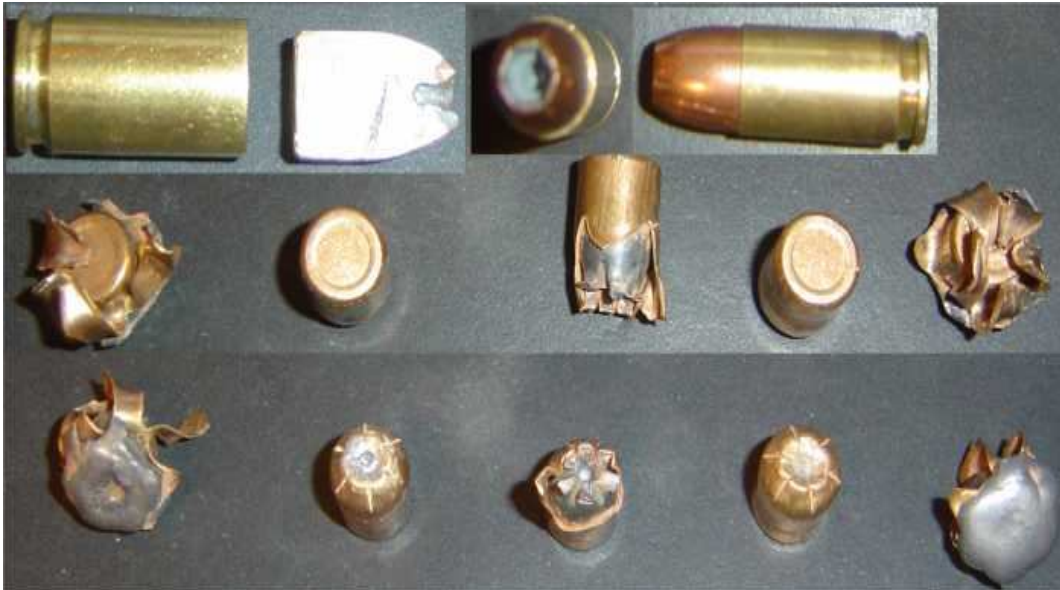
Bala de punta hueca marca MAGTECH (CBC) de 9x19 Parabellum. De izquierda a derecha, impacto sobre dos tacos de moqueta, madera y chapa, madera, chapas metálicas y sobre cuatro capas de cuero. FOTO: KOKO
