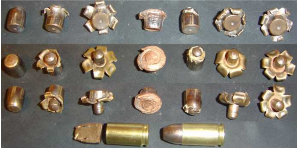
Bala poliefectos o EMB-Expansive Mono Block de Hirtenberg (JI0105). Impacto sobre dos chapas metálicas, madera, moqueta, chapas metálicas, tres tablas de madera, bloque de arcilla y 4 capas de cuero. FOTO: KOKO
