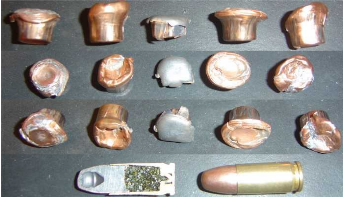
Bala KPO (Kimpoamaton Poliisiluoti Onnto) de la finlandesa SAKO. Impacto sobre chapa de madera y metálica, sobre madera, sobre moqueta, sobre dos chapas metálicas, y sobre tres tablas de madera. FOTO: KOKO
