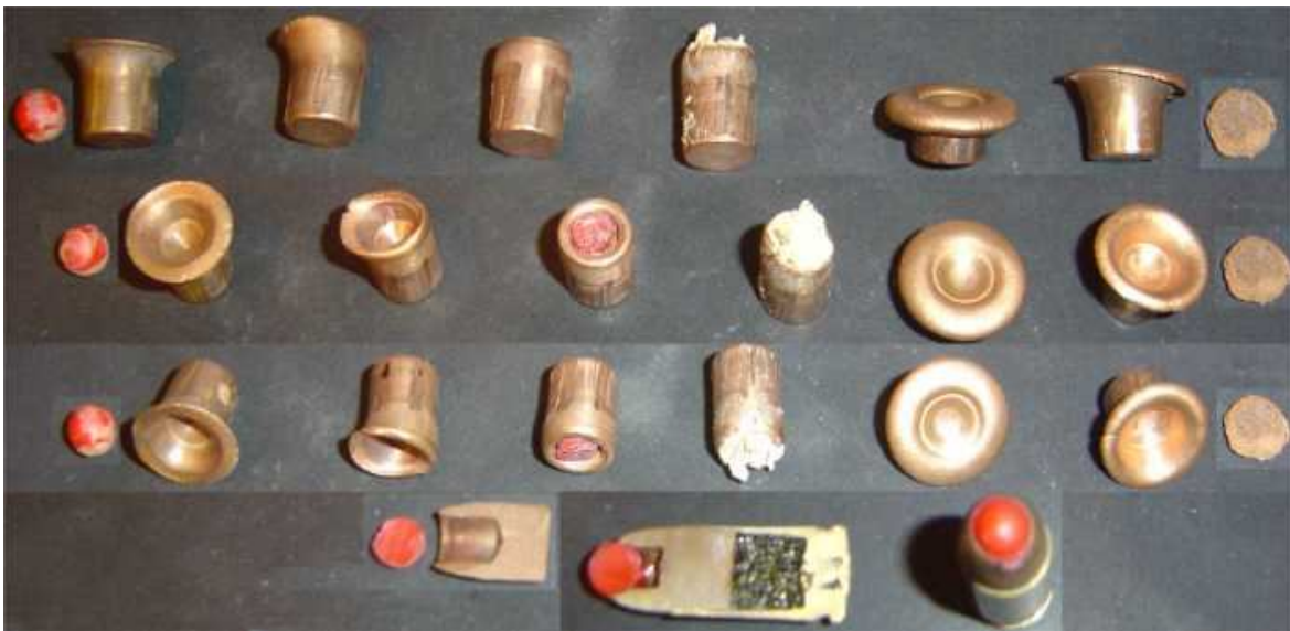
Bala MEN QD1. Impacto sobre moqueta, madera, dos chapas metálicas, tres tablas de madera, una capa de cuero y un bloque de arcilla, y sobre 4 capas de cuero y un bloque de arcilla. FOTO: KOKO
