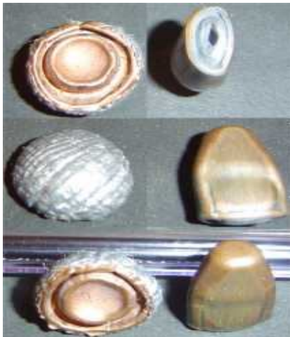
Bala blindada ordinaria disparada contra un chaleco antibalas (izquierda) y casi paralela contra una pared. FOTO: KOKO
