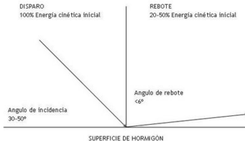
Gráfico 1. Distribución de Energía Cinética del proyectil y de los ángulos de incidencia y de rebote en caso de rebote sobre hormigón con fragmentación del proyectil.
